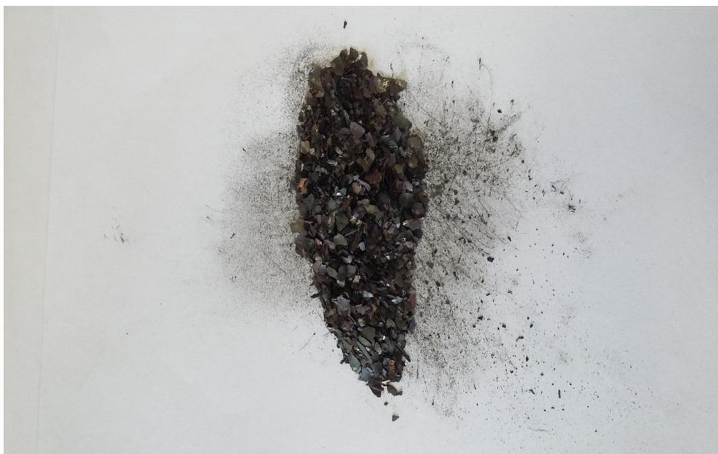
Figura 5. Componentes eletroativos isolados após eliminação do solvente não aquoso e raspagem manual. Fonte: autor (2016).
