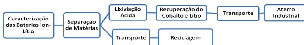
*Figura 13. Rota de lixiviação ácida*
