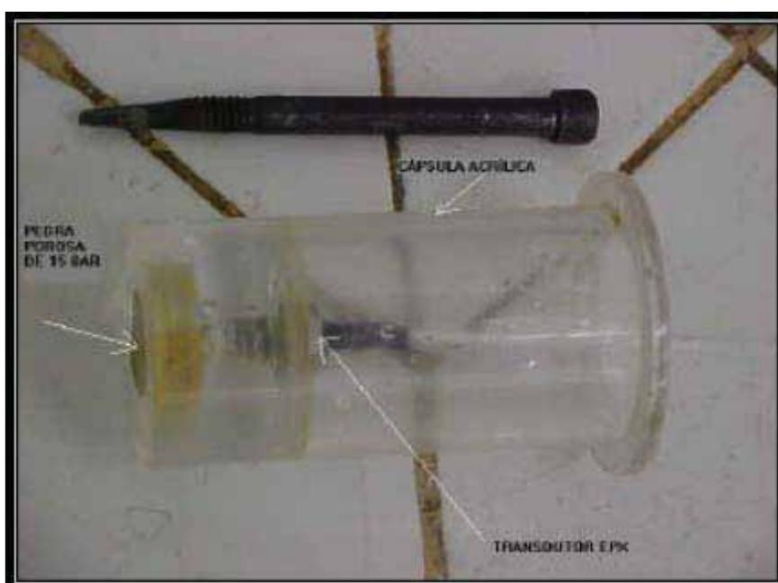
Figura 2.8. Tensiômetro TENSE EXP1 (DIENE, 2004)
