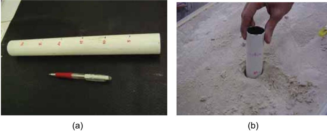
Figura 6.28. (a) “Amostrador” para a retirada de um perfil de umidade; (b) detalhe da cravação no solo.
