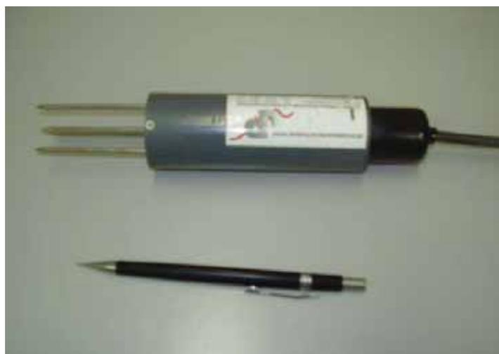
Figura 5.24. TDR usado, modelo ThetaProbe ML1.
