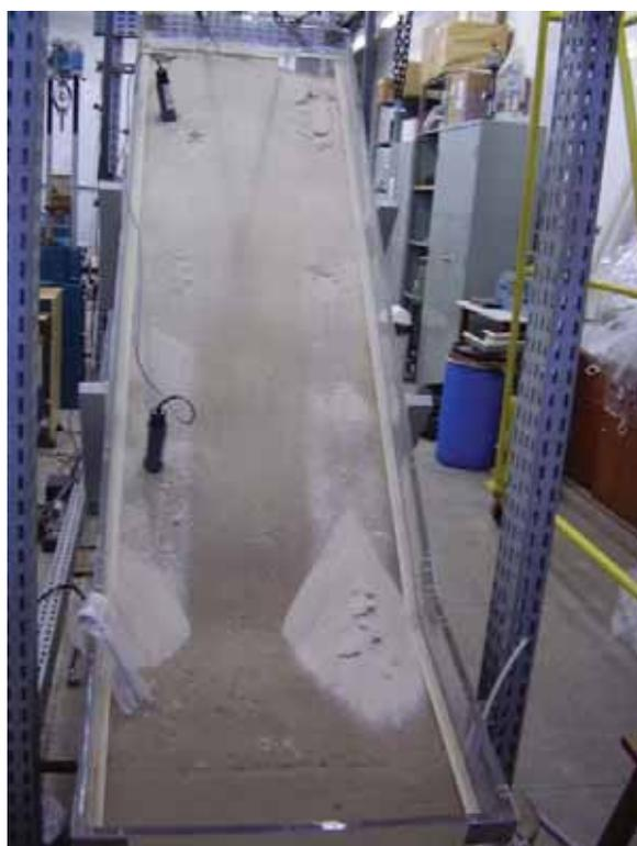
Figura 6.26. Fluxo do material seco proveniente da crista devido ao aumento da inclinação (42,5°).
