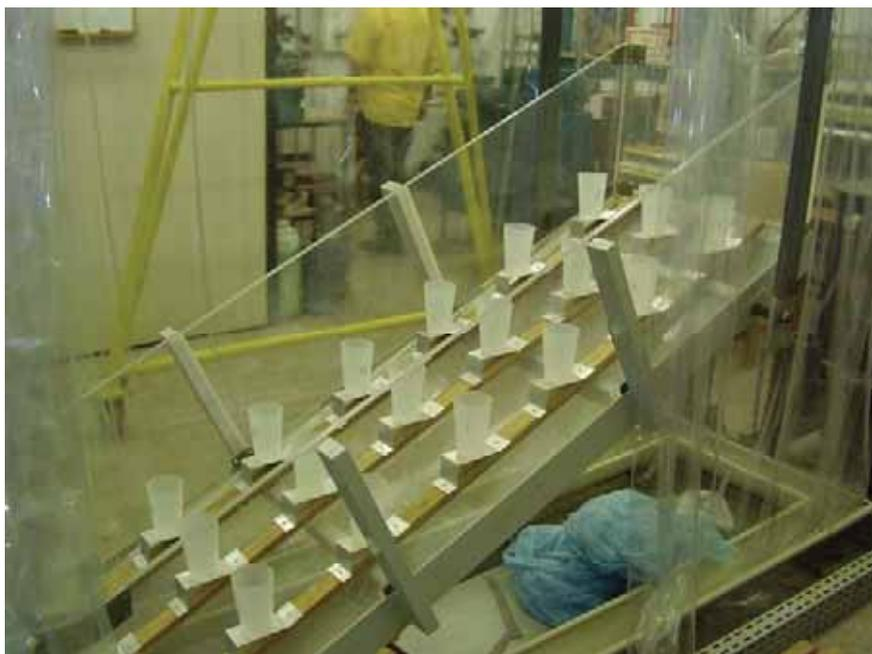
Figura 5.20. “Pluviômetros” para a medição da uniformidade da chuva aplicada.
