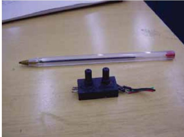
Figura 5.15. Detalhe do transdutor de Sensym.
