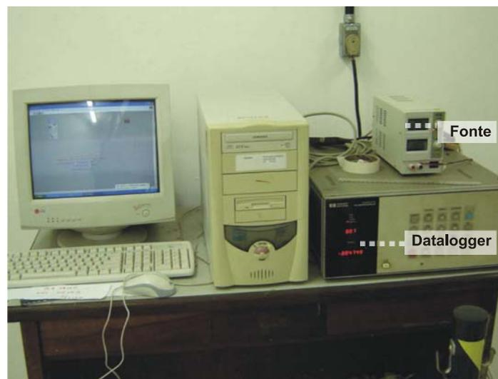
Figura 3.26 – Sistema de aquisição de dados para os ensaios de fluência.
