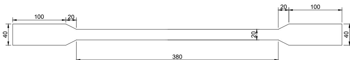
Figura 3.20 – Dimensões nominais dos corpos de prova utilizados nos ensaios de fluência a tração do material compósito extraído dos perfis pultrudados de seção H (medidas em mm).
