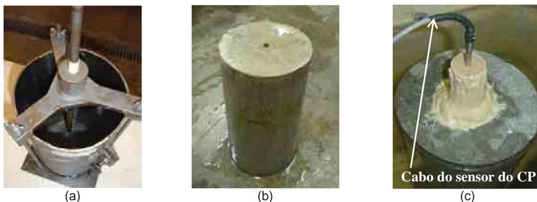
**Figura 5.48 - Ensaio de difusividade do concreto: (a) Molde metálico; (b) Corpo-de-prova com orifício no centro e (c) tubo de PVC e gesso para isolar o contato da água.**
