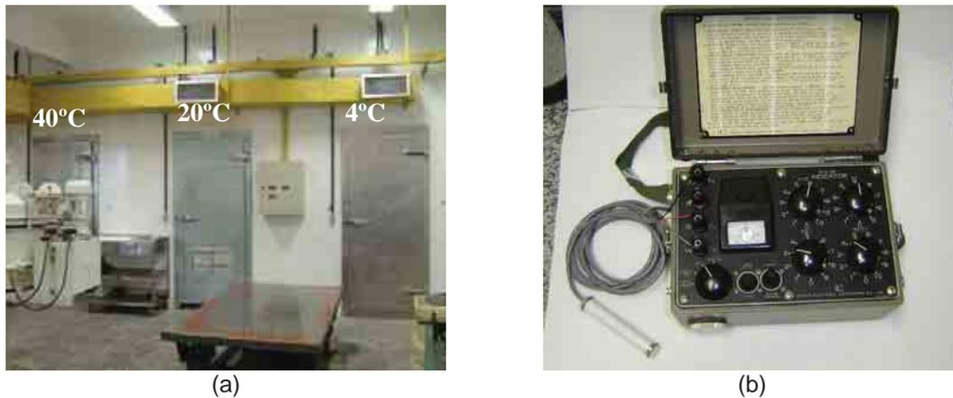
**Figura 5.51 - Ensaio de coeficiente de dilatação térmica do concreto: (a) salas com controle de temperatura e (b) ponte de leitura para medição das temperaturas e das deformações.**
