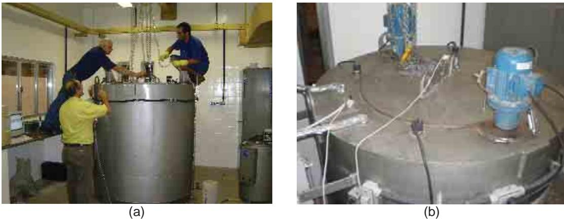
**Figura 5.46 –Fechamento do calorímetro e colocação dos termômetros.**
