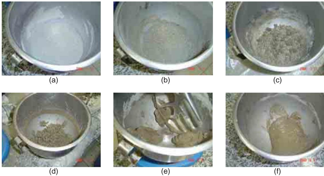
**Figura 5.9** Fases do empacotamento de ensaio de demanda d'água para materiais finos: (a) cimento anidro; (b) fase seca; (c) estado pendular; (d) estado funicular; (e) início da fase capilar (ponto de saturação) e (f) estado capilar após pequena adição de água.
