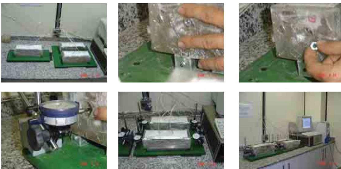
**Figura 5.30 Procedimento de colocação dos extensômetros para determinação da retração autógena, antes da desforma.**
