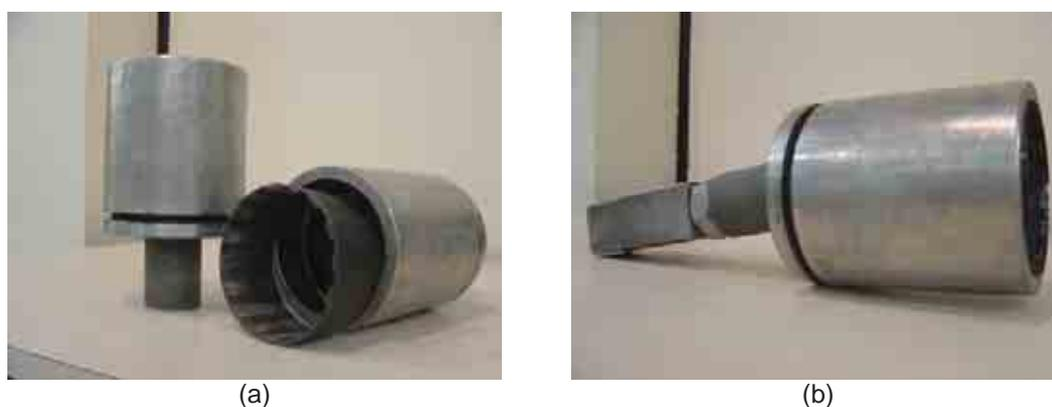
**Figura 5.39 - Dispositivos para ensaio de tração direta desenvolvido por LEROY (PACELLI *et al.*, 1997) e modificado na COPPE: (a) Os dois cilindros de aço (capacetes) e detalhe da mola circular para prender a base e o topo do corpo-de-prova; (b) conjunto de mola encaixada no interior do capacete, fixados às barras de aço rosqueadas, que se prendem às garras da prensa.**
