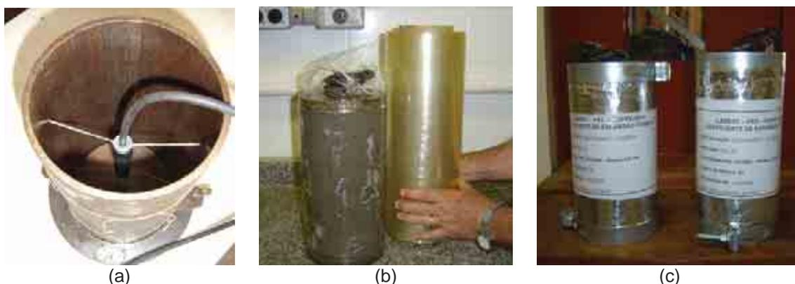
**Figura 5.50 - Ensaio de coeficiente de dilatação térmica do concreto: (a) fixação do extensômetro no molde cilíndrico; (b) e (c) envolvimento do corpo-de prova com filme PVC e fita adesiva de alumínio, respectivamente**
