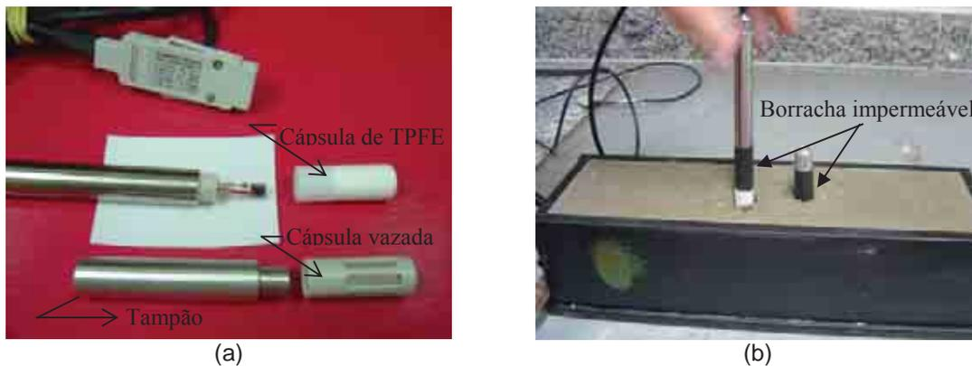
**Figura 5.34 Configuração usada para a introdução da sonda e do tampão no concreto: (a) Sonda + cápsula de TPFE e tampão+cápsula vazada e (b) Detalhe da colocação na moldagem.**
