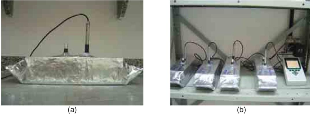
Figura 5.35 (a) Corpo-de-prova selado com filme plástico e fita adesiva de alumínio na sala com  $T = 21^{\circ}\text{C}$  e (b) Sistema de aquisição automática da redução da UR e da temperatura interna do concreto.
