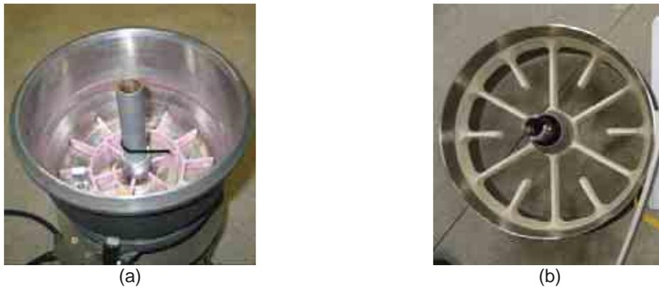
**Figura 5.20 - Colocação de selos de vedação no BTRHEOM: (a) no recipiente fixo (selo interno) e (b) na parte móvel (selo externo).**
