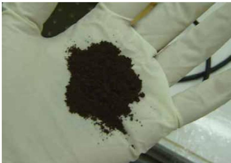
FIGURA 3.4 – Aspecto do pó de despoeiramento do forno elétrico fornecido pela Gerdau.
