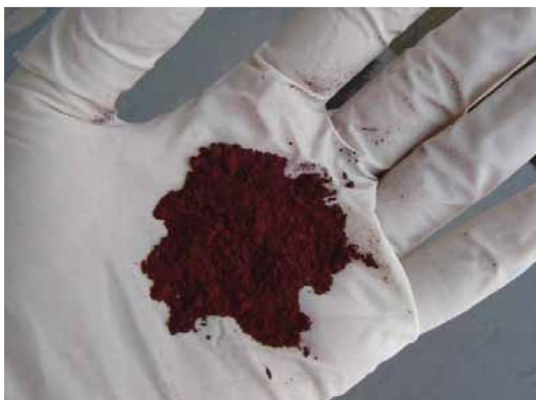
FIGURA 3.6 – Aspecto do Fe<sub>2</sub>O<sub>3</sub> adquirido na B'Herzog.
