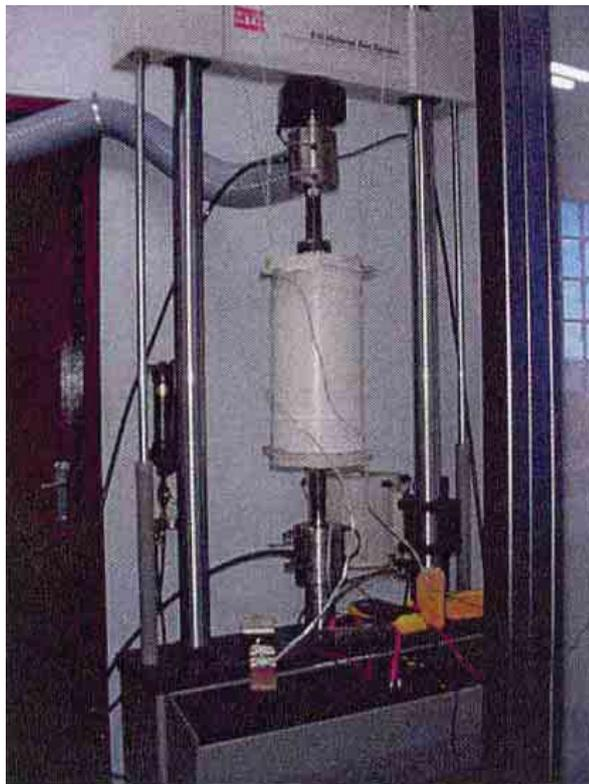
Figura 5.42. Atuador servo-hidráulico com o amortecedor e estufa instalados.
