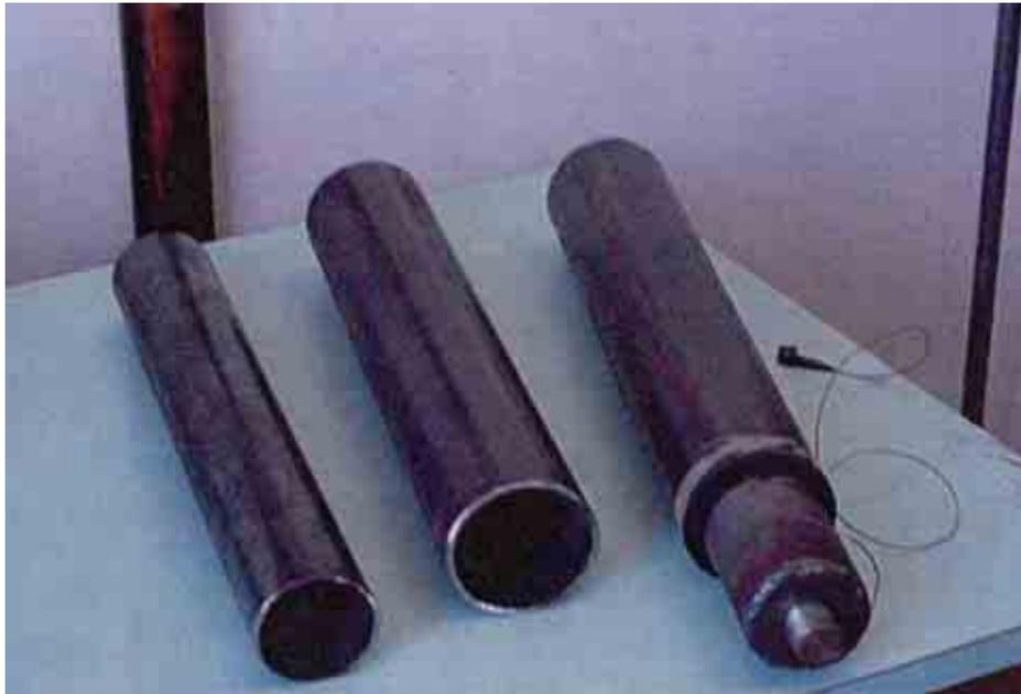
Figura 5.40. Amortecedor viscoelástico pronto para o ensaio [31].
