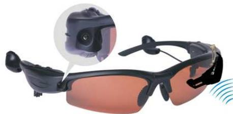
Figura 1.3b – Óculos com câmera e monitor sem fio
