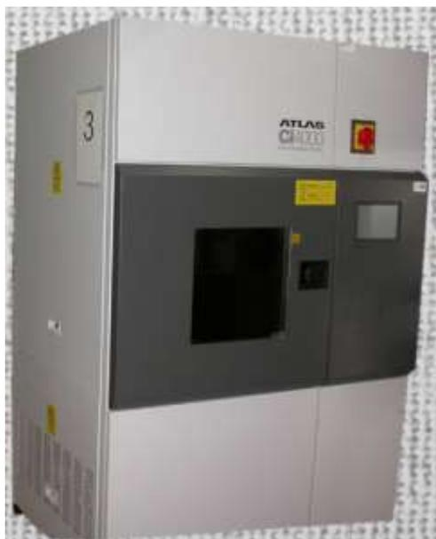
Figura 2.33 - Equipamento Weatherometer para o ensaio de envelhecimento de tintas e ligantes asfálticos
