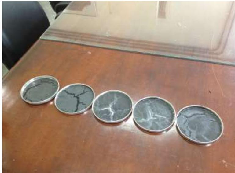
Figura 3.7 - Aparência das Amostras (L1→L5) após um mês de exposição ao tempo
