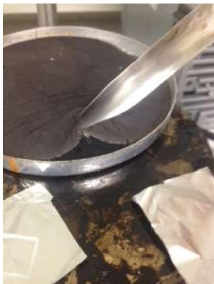
Figura 3.9 - Aparência da Amostra (L1) após um ano de exposição ao tempo
