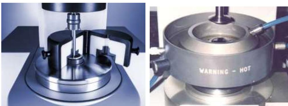
Figura 2.39 - Modelos de Reômetro de Cisalhamento Dinâmico (DSR)
