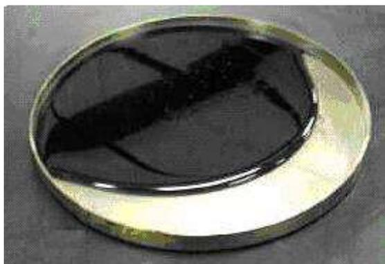
Figura 2.26 - Prato para TFOT com amostra de ligante asfáltico inicial sendo espalhada
