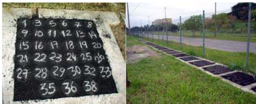
Figura 2.18 - Placas de misturas asfálticas expostas ao tempo (LEITE *et al.*, 2010)
