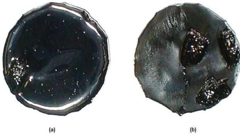
Figura 2.23 - Corpo de prova do ligante BRA (a) antes do efeito exposição aos raios UV e (b) depois do efeito exposição aos raios UV (SILVA, 2005)
