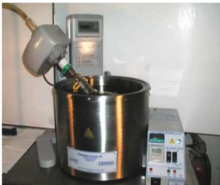
Figura 2.29 - Esquema do RFT para o ensaio de envelhecimento de ligantes asfálticos
