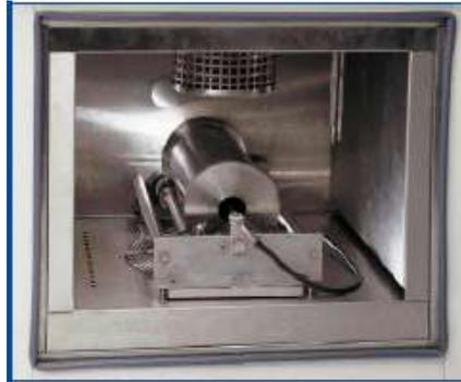
Figura 2.32 - Equipamento para RCAT para o ensaio de envelhecimento de ligantes asfálticos (VERHASSELT e CHOQUET, 1993)
