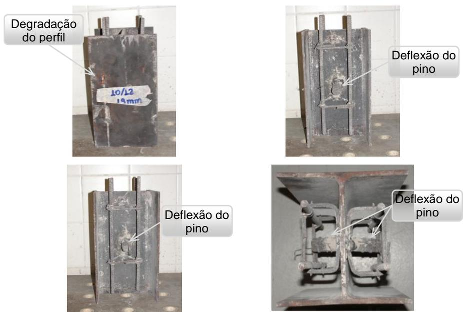
Figura 3.34b – Estado do modelo após o ensaio com o concreto retirado (M2T60019)
