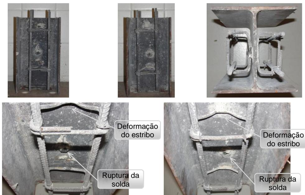
Figura 3.22b – Estado dos modelos após os ensaios com o concreto retirado (M2T60012)
