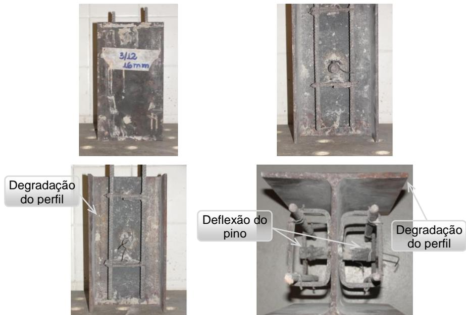
Figura 3.28a – Estado dos modelos após os ensaios com o concreto retirado (M1T60016)
