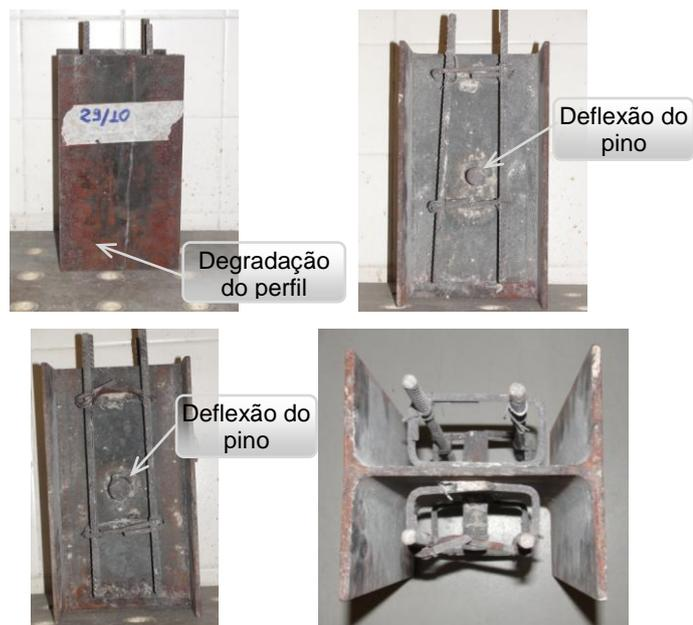
Figura 3.34a – Estado do modelo após o ensaio com o concreto retirado (M1T60019)
