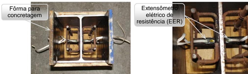
Figura 2.7 – Extensômetros elétricos de resistência colados nos conectores
