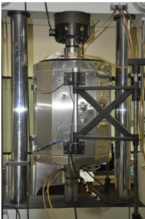
Figura 3.6 – Estufa para ensaios a altas temperaturas
