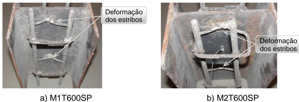
Figura 3.16 – Estado dos modelos após os ensaios com o concreto retirado (Sem pino)
