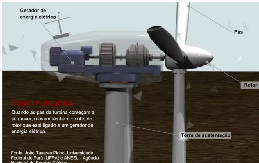
Figura 2.5 : Esquematização de uma nacelle (SANTANA, 2009).
