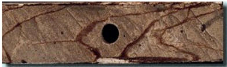
**Figura 1.8.2 – Testemunho fraturado e recoberto de lama de perfuração a base de óleo. (Reproduzido de [www.geotechnical-services.com.au/Contamination.htm](http://www.geotechnical-services.com.au/Contamination.htm))**
