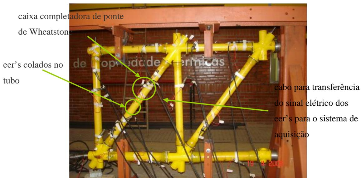
Figura 5-8 – Estrutura instrumentada (foto do ensaio 1).
