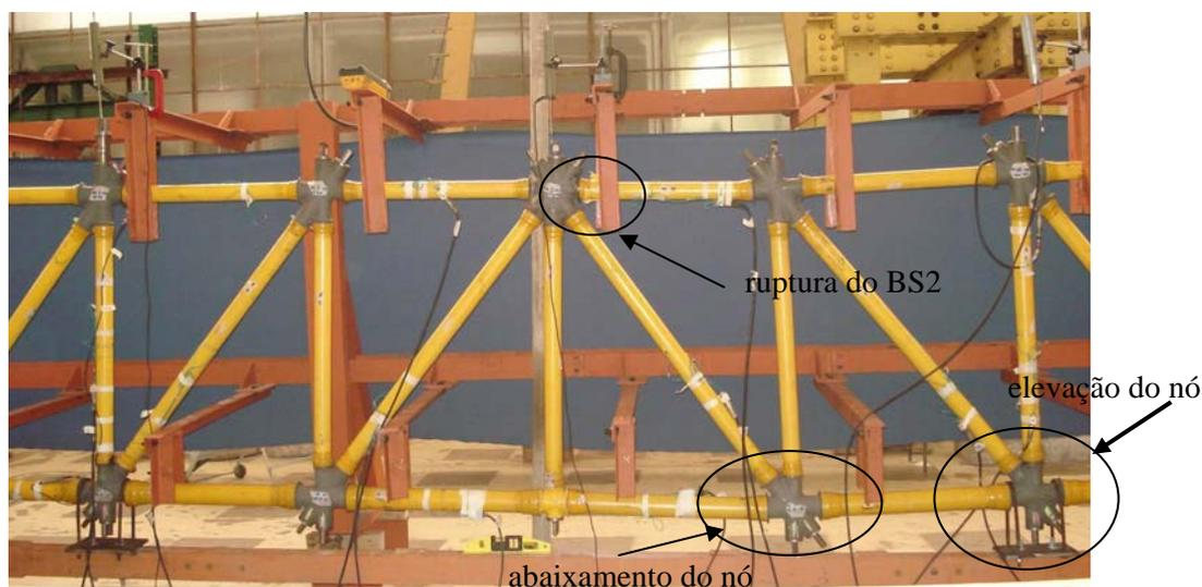
Figura 6-25 – Montagem 2: ruptura do banzo superior em BS2.
