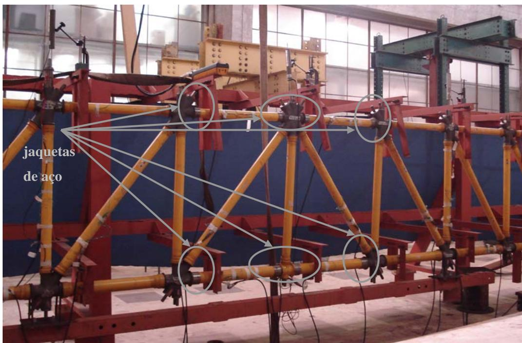
Figura 6-42 – Montagem 3: carregamento da estrutura.
