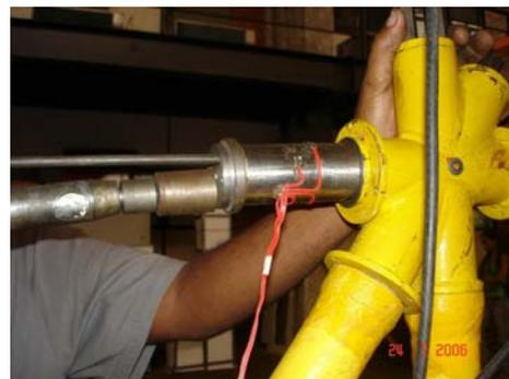
Figura 5-5 – Aplicação das protensões: (a) banzo inferior (foto do ensaio 1); (b) banzo superior (foto do ensaio 4).
