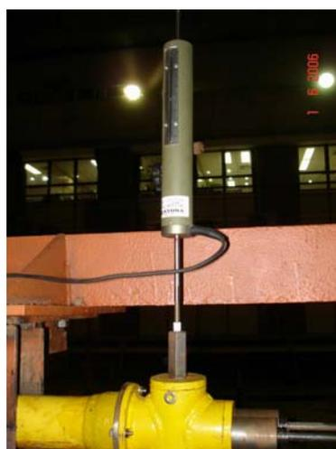
Figura 5-9 – Flexímetro sobre o nó superior do montante M1 (foto do ensaio 3).
