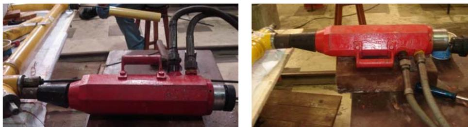
Figura 6-10 – Protensão dos banzos da treliça na bancada: (a) inferior; (b) superior.
