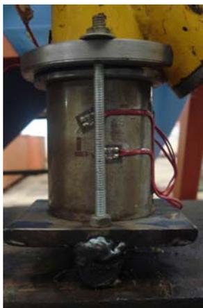
Figura 6-13 – Célula de carga do apoio à direita (ccAD) modificada.
