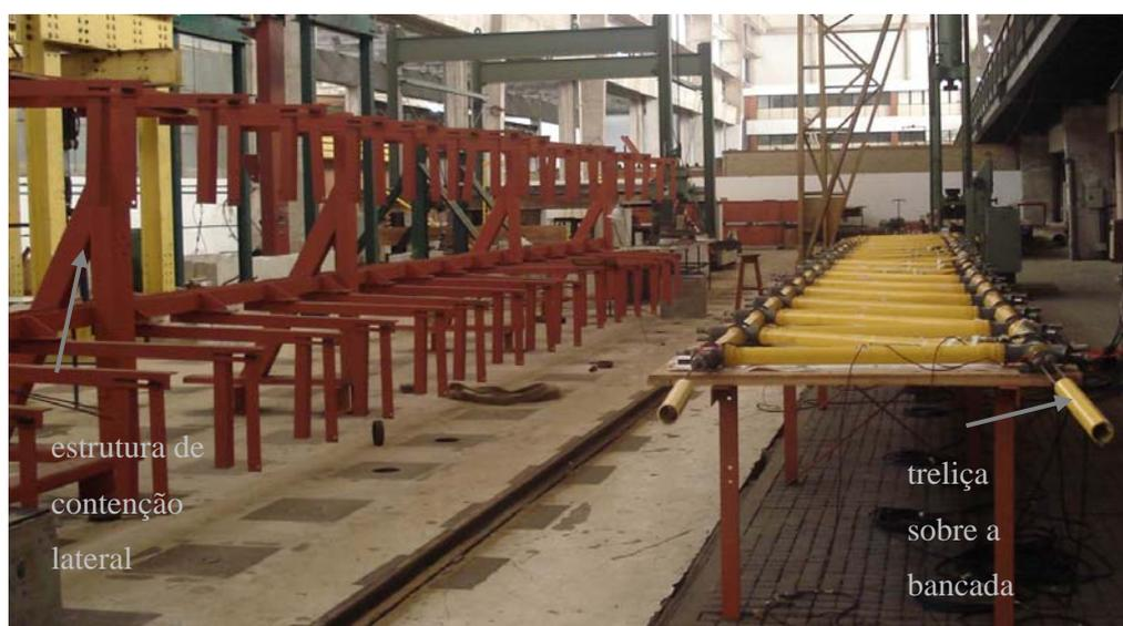
Figura 6-9 – Estrutura de contenção lateral e treliça sobre a bancada.
