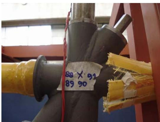
Figura 6-23 – Detalhe da ruptura do banzo superior.
