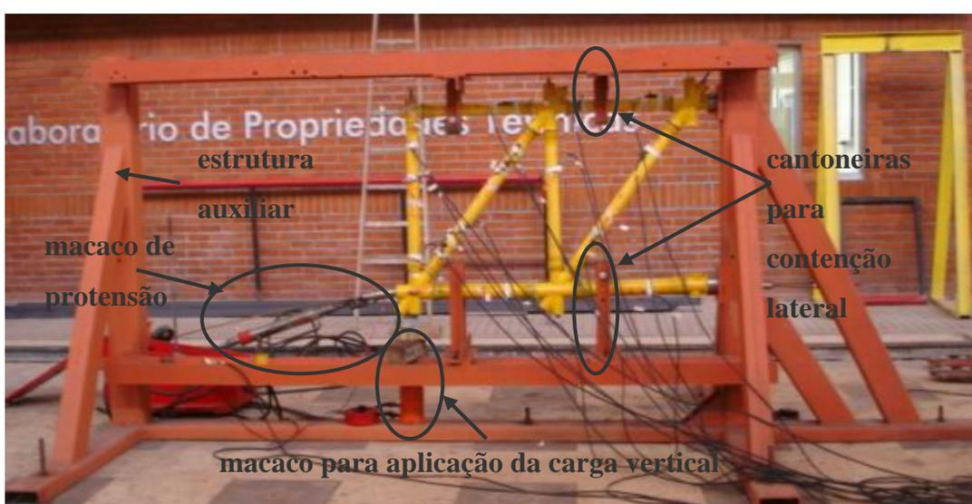
Figura 5-1 – Estrutura em painéis, engastada e contida lateralmente pela estrutura auxiliar (foto do ensaio 1).
