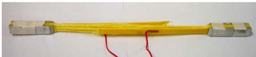
Figura B-18 – Amostra 13 após o ensaio.
