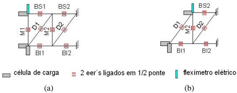
Figura 5-7 – Instrumentação dos painéis: (a) ensaios 1, 2 e 3; (b) ensaio 4.
