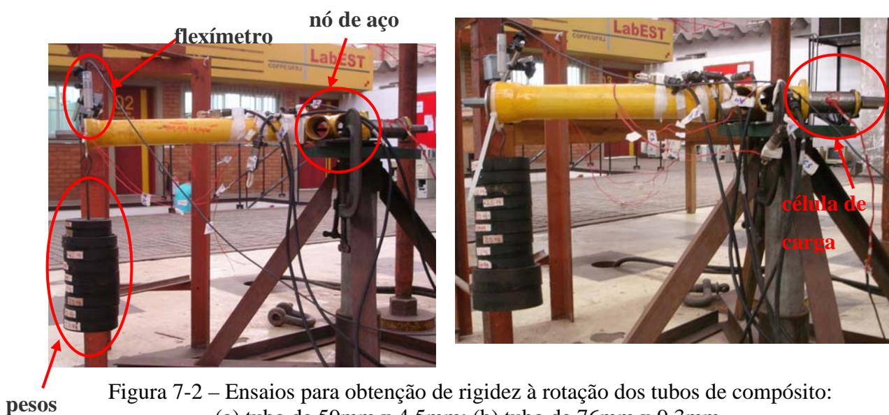
Figura 7-2 – Ensaios para obtenção de rigidez à rotação dos tubos de compósito: (a) tubo de 59mm x 4,5mm; (b) tubo de 76mm x 9,3mm.
