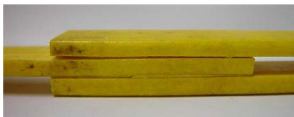
Figura B-32 – Detalhe da amostra rompida no ensaio 2.
