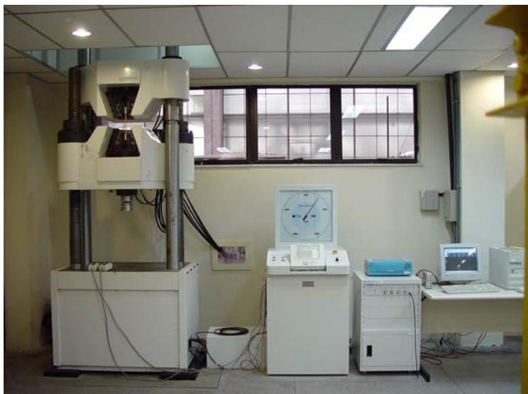
Figura B-5 – Equipamentos utilizados no ensaio de tração.
