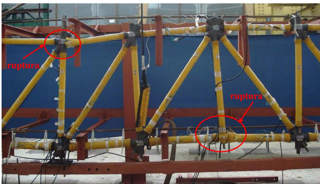
Figura 6-22 – Treliça rompida no banzo inferior e no banzo superior.
