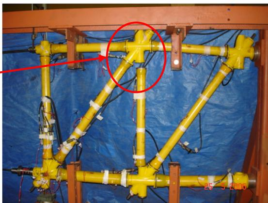
Figura 5-11 – Vista da treliça rompida do ensaio 2.
