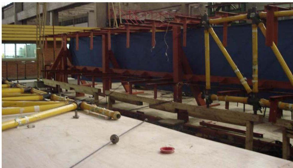
Figura 6-24 – Desmontagem da treliça rompida.
