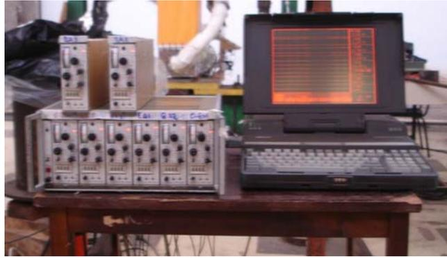
Figura 7-3 – Sistema de aquisição do ensaio de rigidez à rotação.
