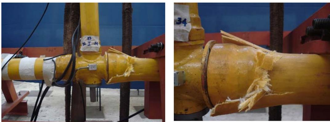
Figura 6-21 – Detalhes da ruptura do banzo inferior.
