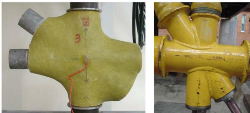
Figura 2-4 – Nós de ligação: (a) de compósito; (b) de aço.
