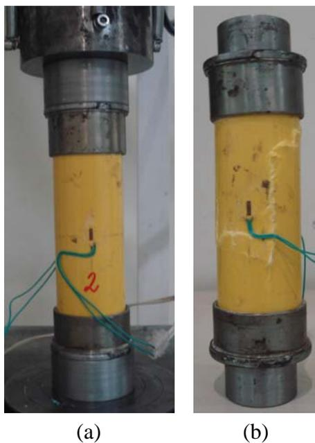
Figura 6-39 – Amostra 2: (a) na prensa; (b) rompida
