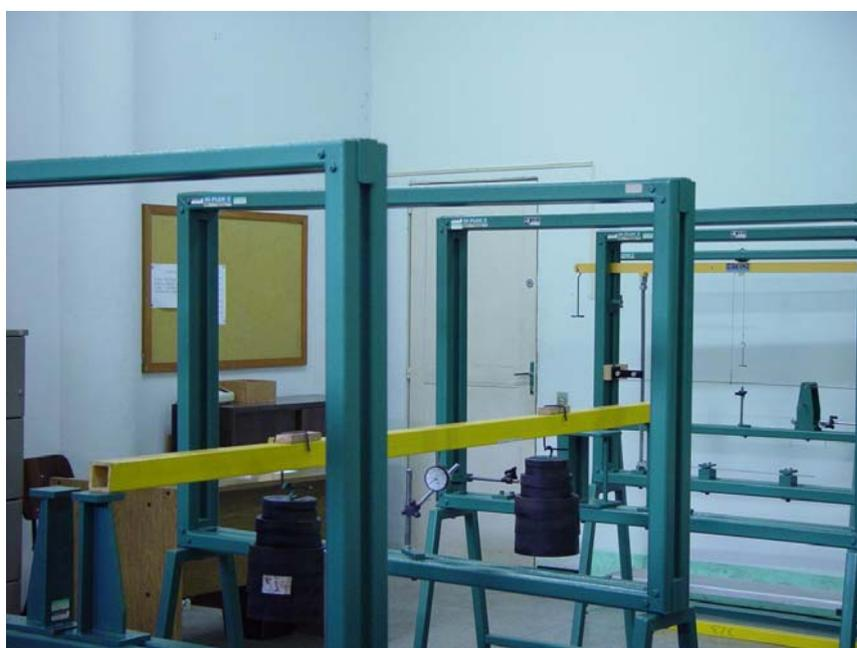
Figura 3-5 – Ensaio de flexão do tubo de dois metros de comprimento.
