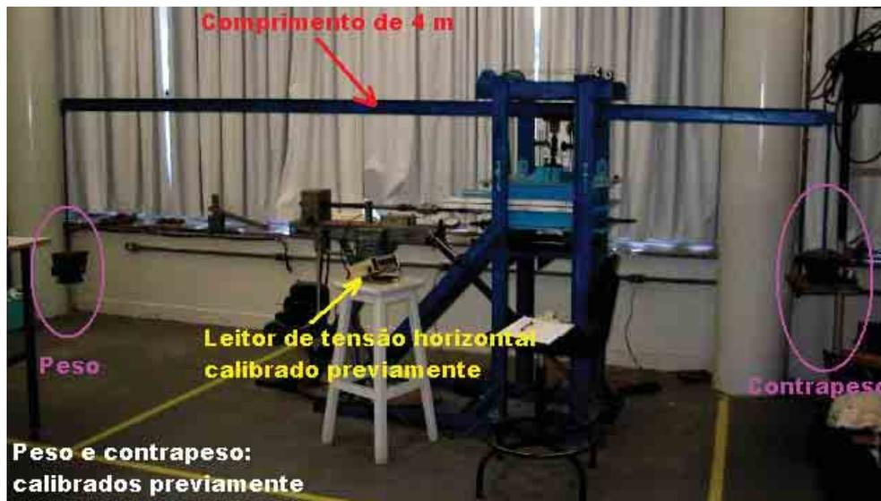
Figura 3.17. Ensaios de grande dimensão no ITA – Aparelhos calibrados.
