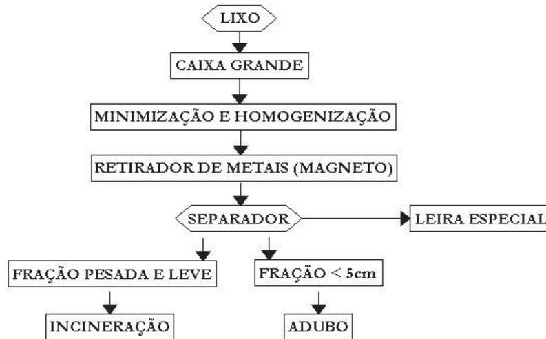
Figura 2.3. Esquema operacional do sistema KIRCHDORF (Fricke et al, 1995).
