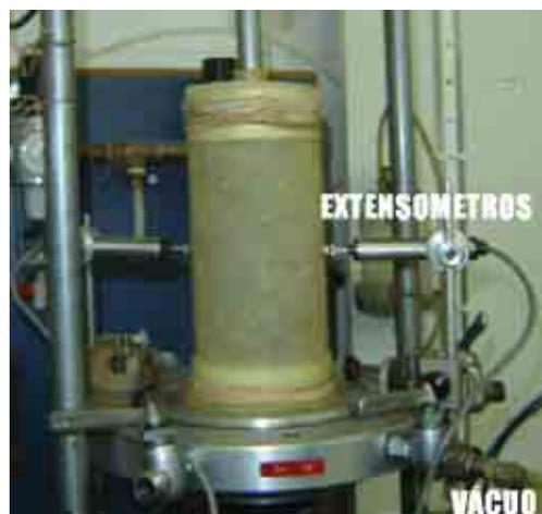
Figura 3.15. Ensaio triaxial aplicando vácuo.
