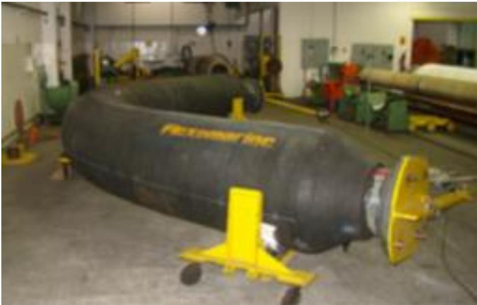
Figura A.1– Ensaio de flexão orientado pelos procedimentos do OCIMF (FLEXOMARINE, 2010).
