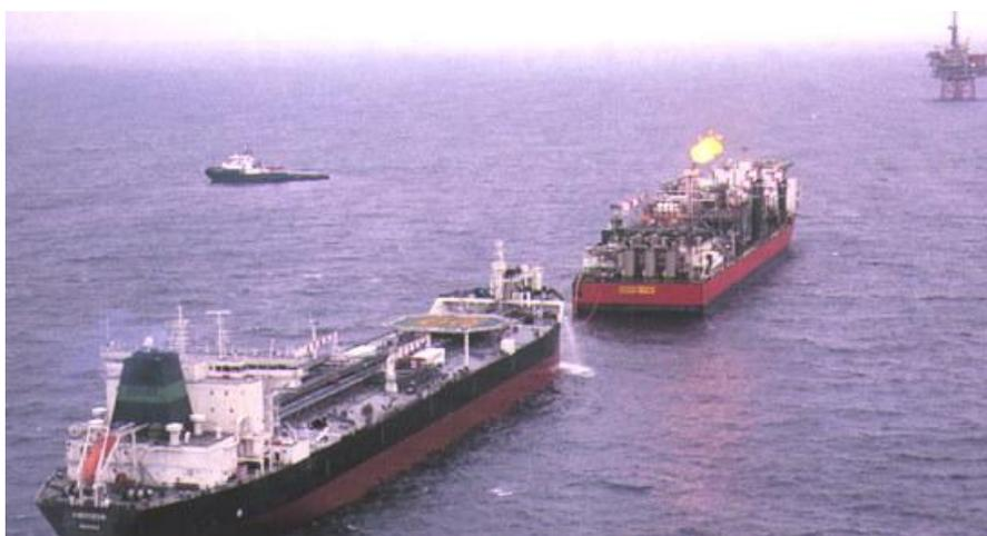
*Figura I.2 – FPSO Captain ao realizar a operação de descarregamento em um Shuttle Tanker no Reino Unido (TEXACO, 2001).*
