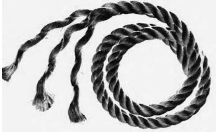
Figura II.6 – Corda de Cânhamo ilustrando a composição de uma cordoalha em maior escala – filamentos, fios, cordoalha (MCDONNEL, 2006).
