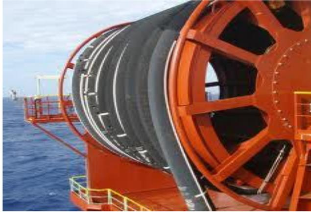
*Figura 1.4 – Armazenamento de linha de mangotes em carretéis (TRELLOBORG, 2013)*
