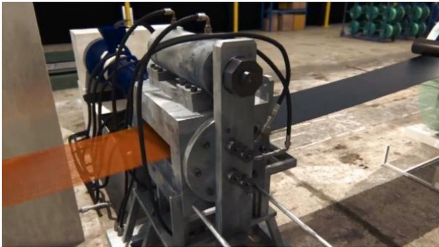
*Figura II.12 – Confeção das camadas compósitas poliméricas para reforço, o "coating" (TRELLEBORG, 2011).*
