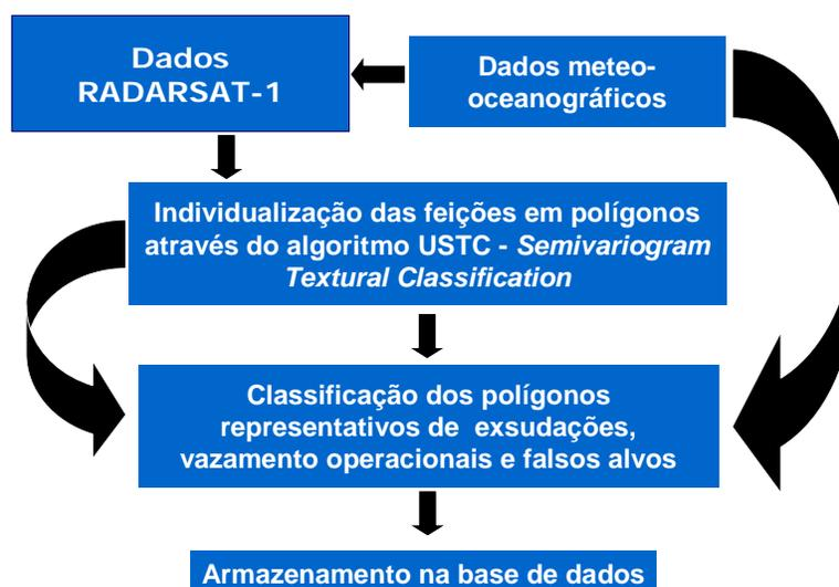
Figura 3.4 – Esquema das principais etapas propostas e realizadas pelo LABSAR para aquisição e processamento digital das imagens RADARSAT-1.
