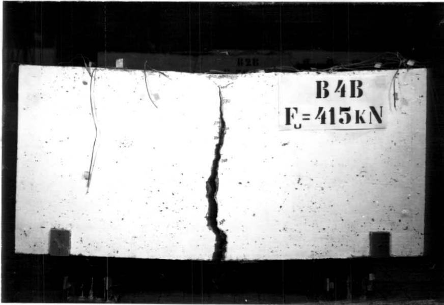
Figura 5.2 - Fotos das fissuras - modelos B4A e B4B
