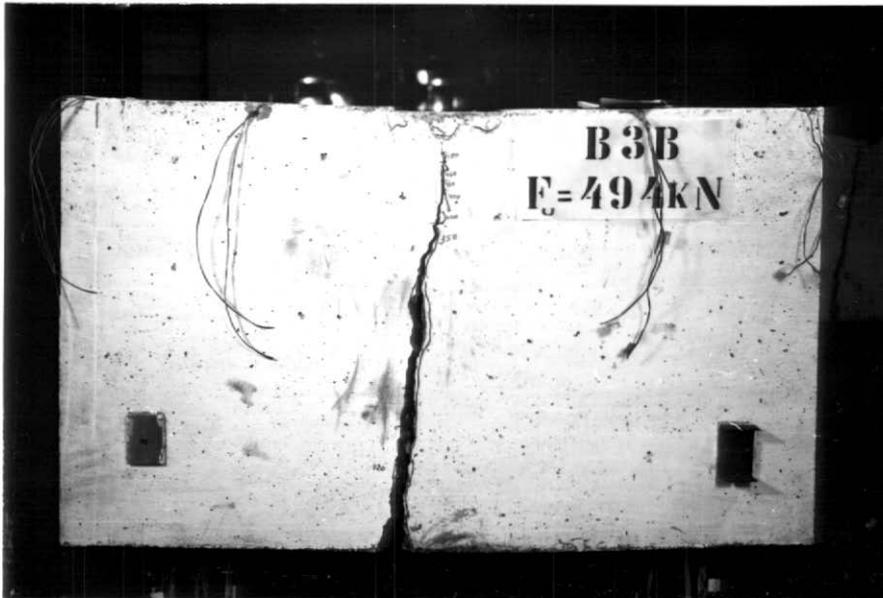
Figura 5.2 - Fotos das fissuras - modelos B3A e B3B
